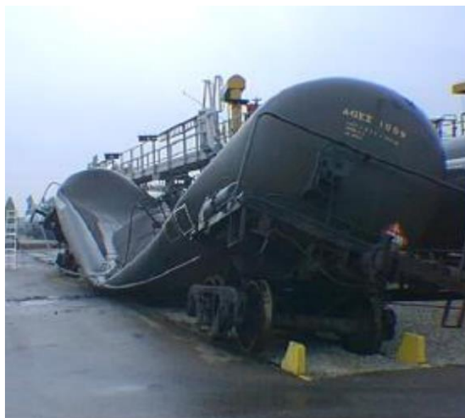
Obrázek 5.12 Ztráta stability skořepinové konstrukce
