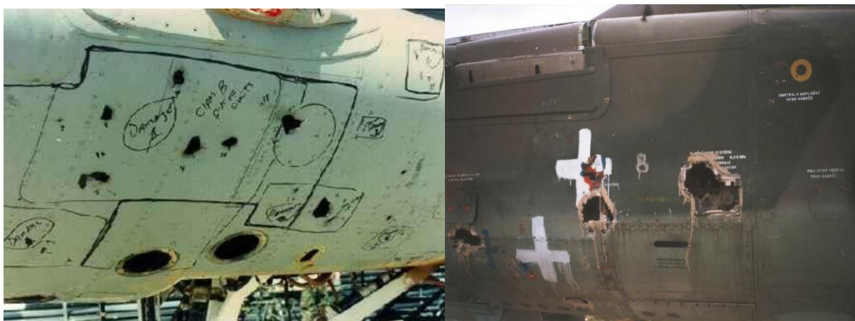
Obrázek 5.8 Poškození trupu [zdroj vedoucí práce]
