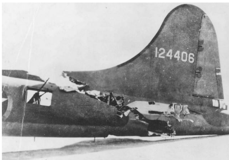
Obrázek 5.10 Poškození letounu B-17 [warhistoryonline.com]
