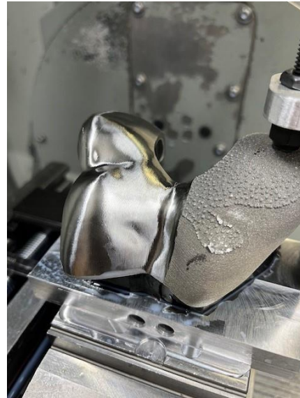
Obr. 123 Obrobená funkčná plocha implantátu.
