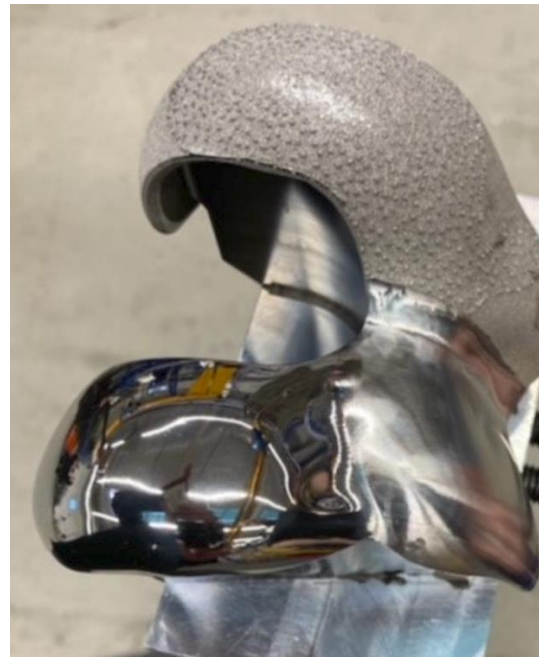
Obr. 124 Ručné leštenie funkčnej plochy.
