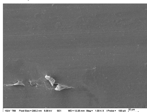
Obr. 53 Kvapalinové trenie, zaťaženie 20 N, indentor Ti štandard.
