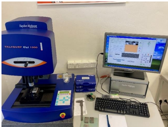
Obr. 65 Meracia aparátúra (vľavo). Kontaktné meranie topografie funkčnej plochy (vpravo).
