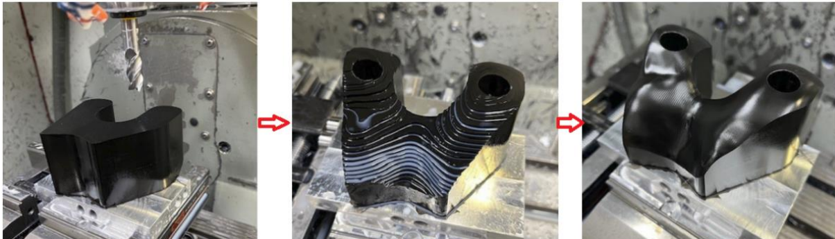
Obr. 119 Frézovanie 2D tvaru → Hrubovanie 3D tvaru a fixačných otvorov → Dokončenie 3D tvaru.
