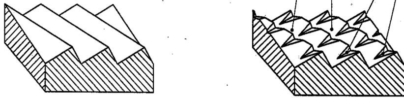
Obrázek 15: Druhy pilníkůvých seků; převzato z (Mošna et al., 2001); jednoduchý sek; křížový sek, 1 – spodní první sek, 2 – horní sek
