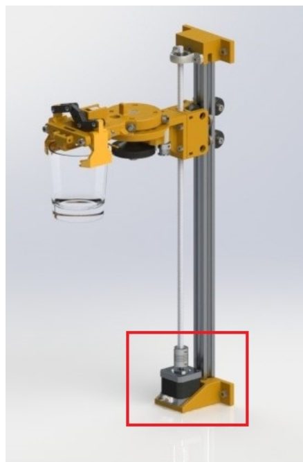
Obr. 3.2: Přehled parametrů bipolárního motoru 17SH4401 a jeho umístění v manipulátoru [18]
