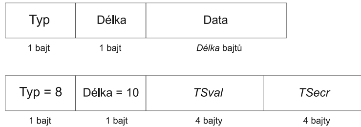
Obrázek 4.2: Obecný formát položky pole TCP Options a položka s časovými razítky TCP.
