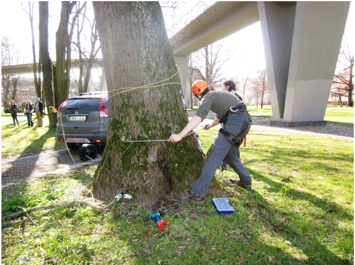
Obr. 41: Tahová zkouška ve Smetanových sadech. Autor Štěpánková J., 20. 3. 2014.
