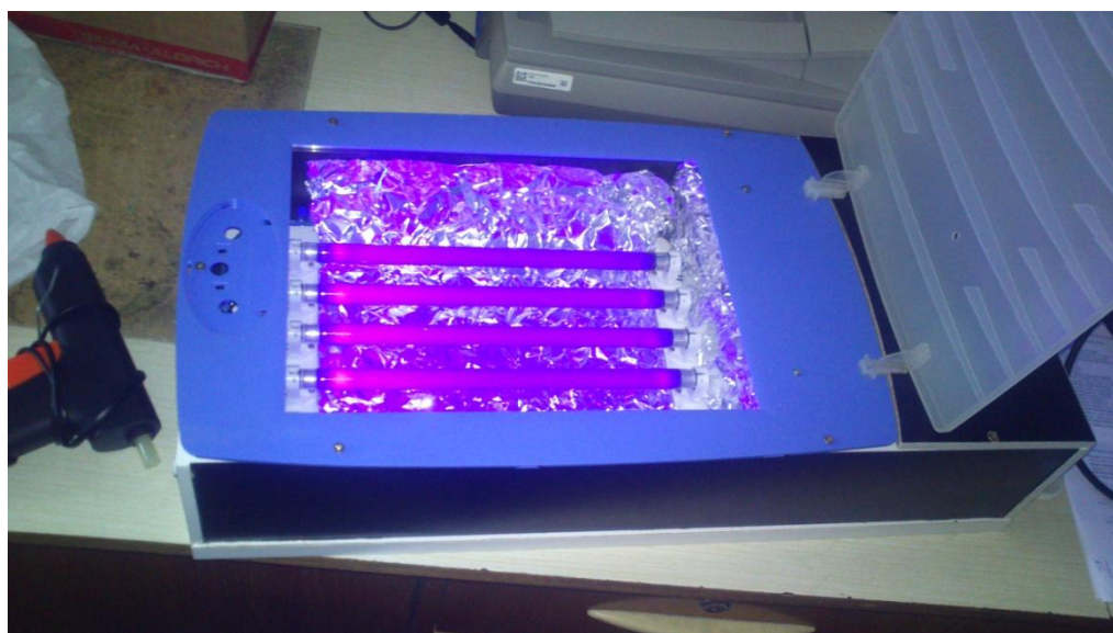
Obr. č. 15 Rozsvícená osvitová jednotka s alobalem a krytem
