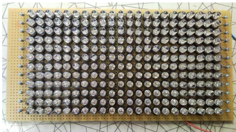
Obr. č. 8 Panel s UV LED diodami; převzato a upraveno z [20]
