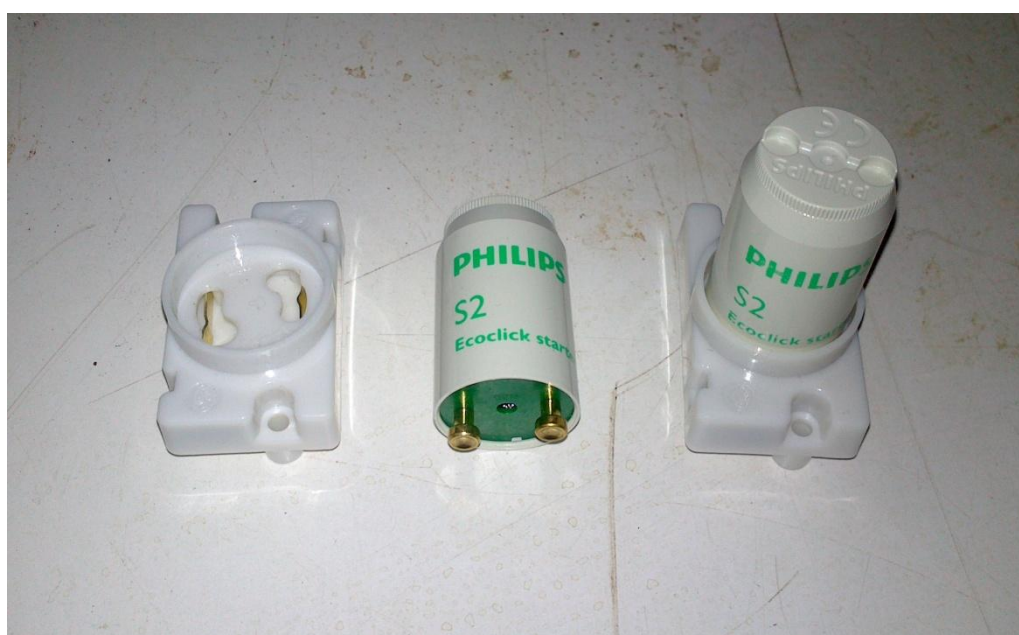
Obr. č. 10 Použité startéry a jejich patice
