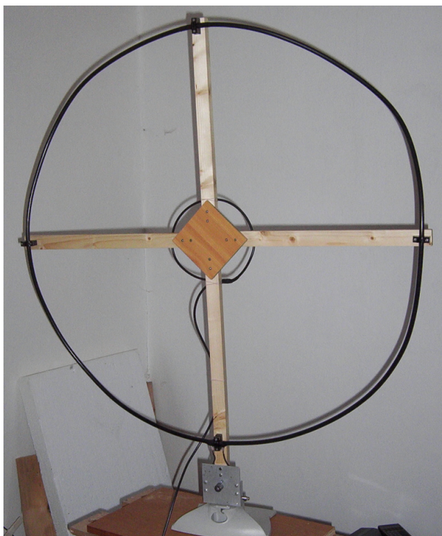
Obr. 1.3: Magnetická smyčková anténa s vazební smyčkou uprostřed [13]
