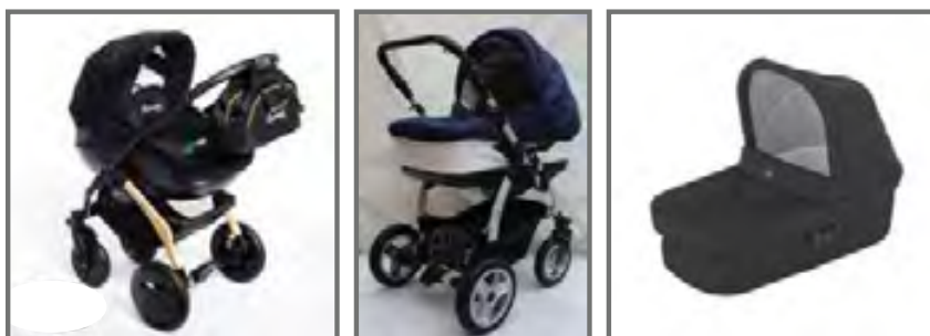
Obr. 1.72, 1.73, 1.74 Korba celo-plastová, plastové dno korby a korba textilní.[34,35,6]
