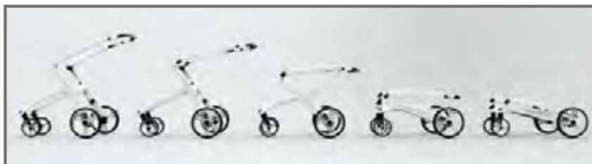
Obr. 5.109 Průběh skládání podvozku.
