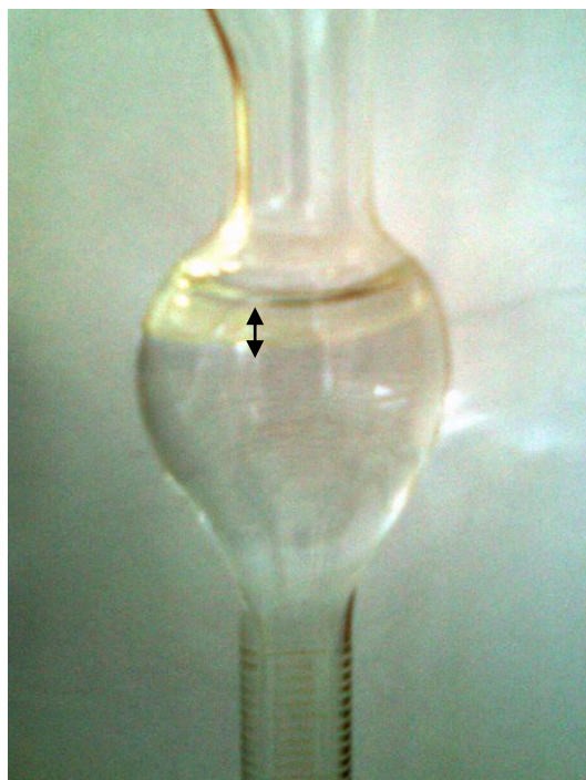
Příloha č. 30: Sloupec zkondenzované silice máty peprné v destilační aparatuře
