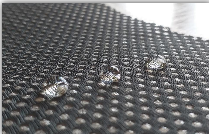
Obrázek 10 Kapky vody, které udržely původní tvar po dobu měření 5 minut
