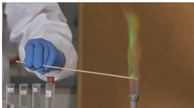
Obr. 14: Zbarvení plamene měďnatými ionty, snímek obrazovky z ref. 49 .
