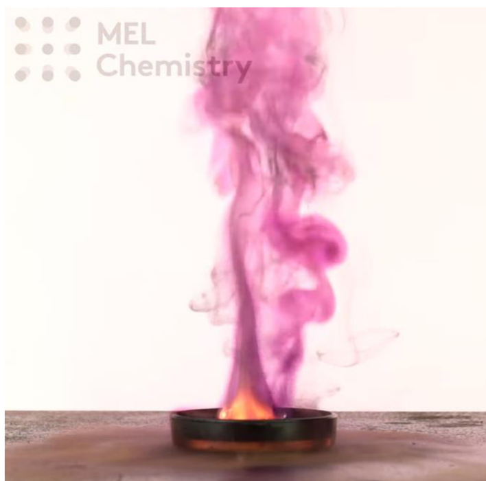
Obr. 16: Fialový kouř z reakce jodu a hliníku s vodou, snímek obrazovky z ref. 51 .
