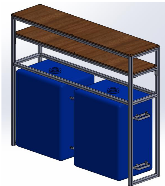
Obr. 48 Model konstrukce s nádržemi
