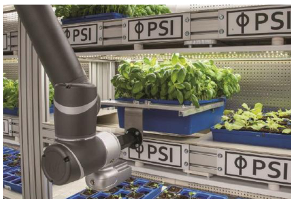
Obr. 54 Přesun traye pomocí gripperu
