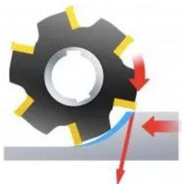
Obr. 10: Schéma sousledného frézování [11]
