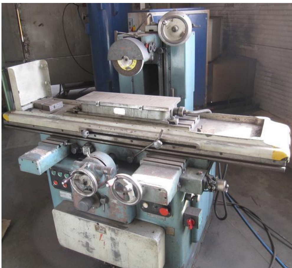
Obr. 2.4 Vodorovná rovinná bruska s přímočarým pohybem stolu 17
