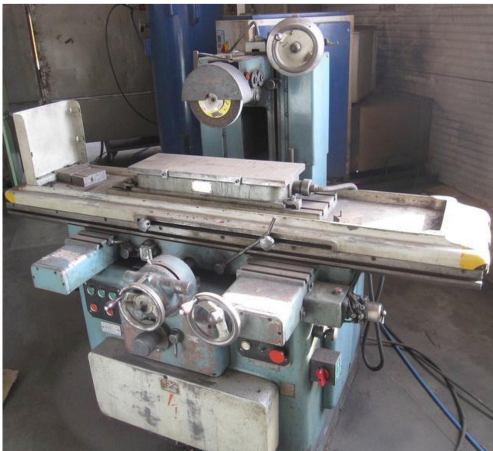
Obr. 2.4 Vodorovná rovinná bruska s přímočarým pohybem stolu 17
