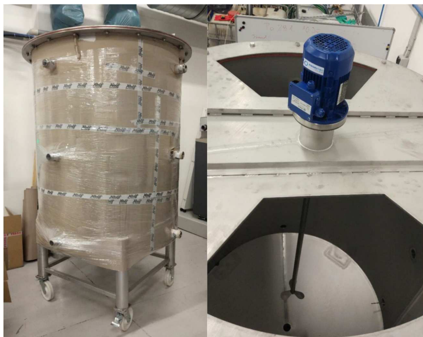
Obr. 12 Akumulační nádrž bez senzorů a míchadla (vlevo), po namontování čerpadla (vpravo) [3]
