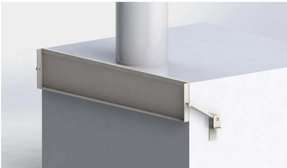
Obr. 27 3D model nasávací klapky na DX55 s pneumatickým válcem [3]
