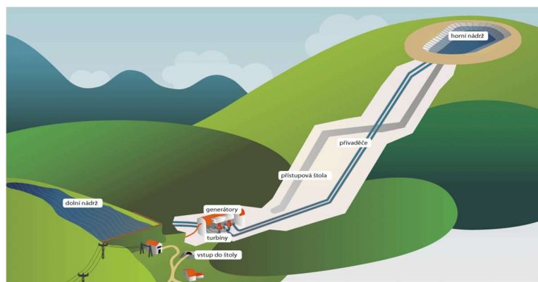
Obrázek 19 Princip fungování přečerpávací vodní elektrárny (Králová)
