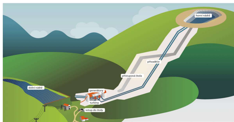
Obrázek 19 Princip fungování přečerpávací vodní elektrárny (Králová)
