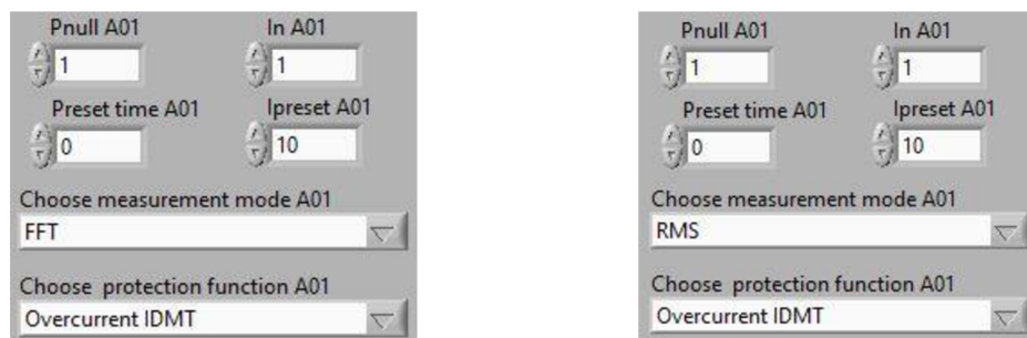
Obr. 68 Nastavenie časovo závislej nadprúdovej ochrany v grafickom užívateľskom prostredí
