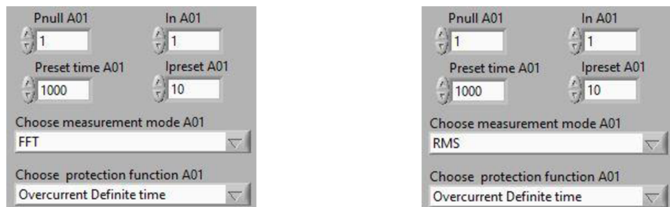
Obr. 66 Nastavenie časovo nezávislej nadprúdovej ochrany v grafickom užívateľskom prostredí
