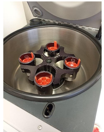
Obrázek č. 7 – Zkumavková metoda – používaná centrifuga Jouan B4i; zdroj: vlastní
