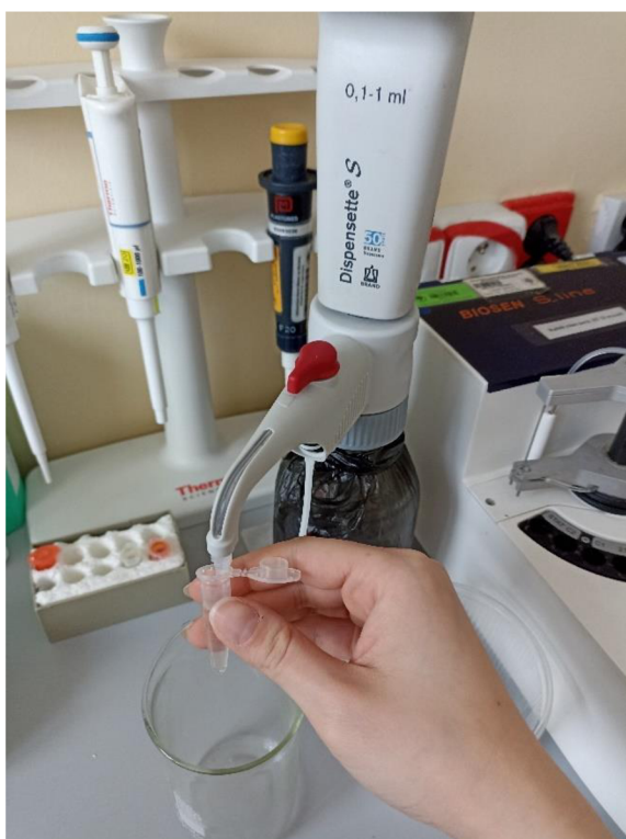
Obrázek č. 14 – Zkumavky Eppendorf s napipetovanou plazmou a systémovým roztokem pro analyzátor glukózy; zdroj: vlastní
