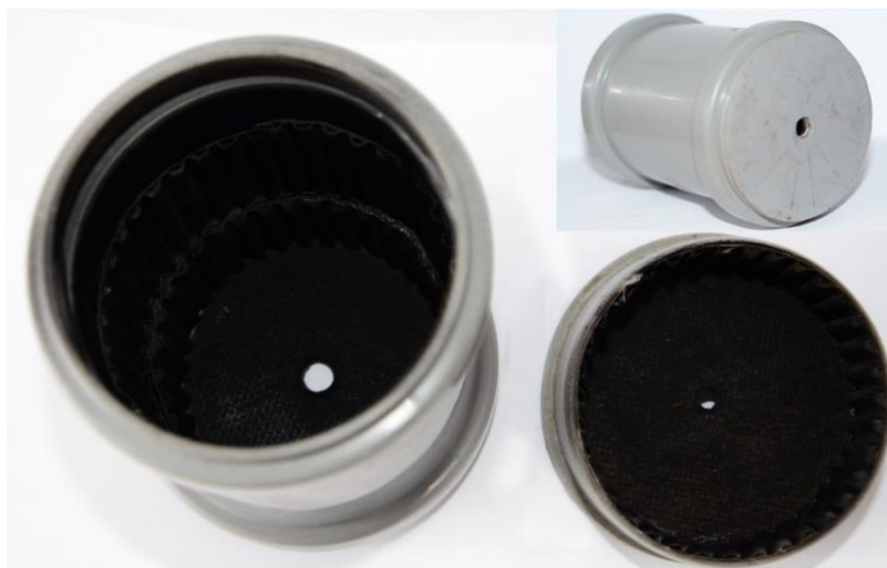
Obr. 3.2: Vyrobený měřicí přípravek
