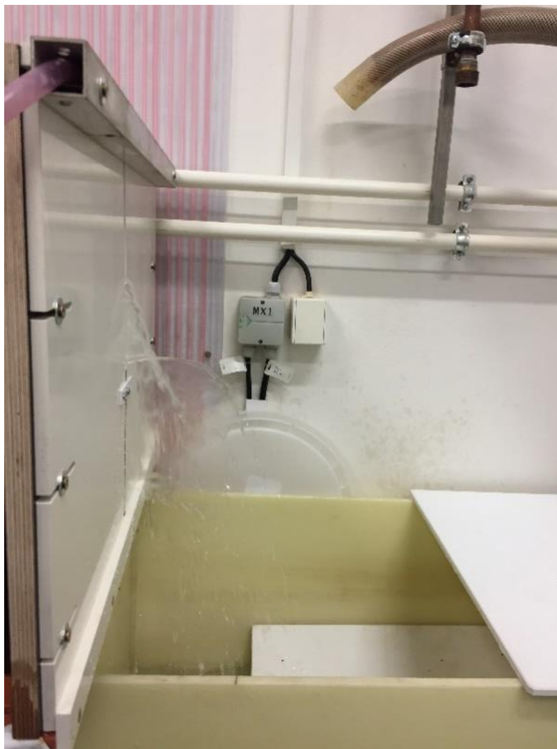
Obr. 20 Přepadový paprsek, šířka štěrbinu 0,002 m, přepadová výška 0,12 m.
