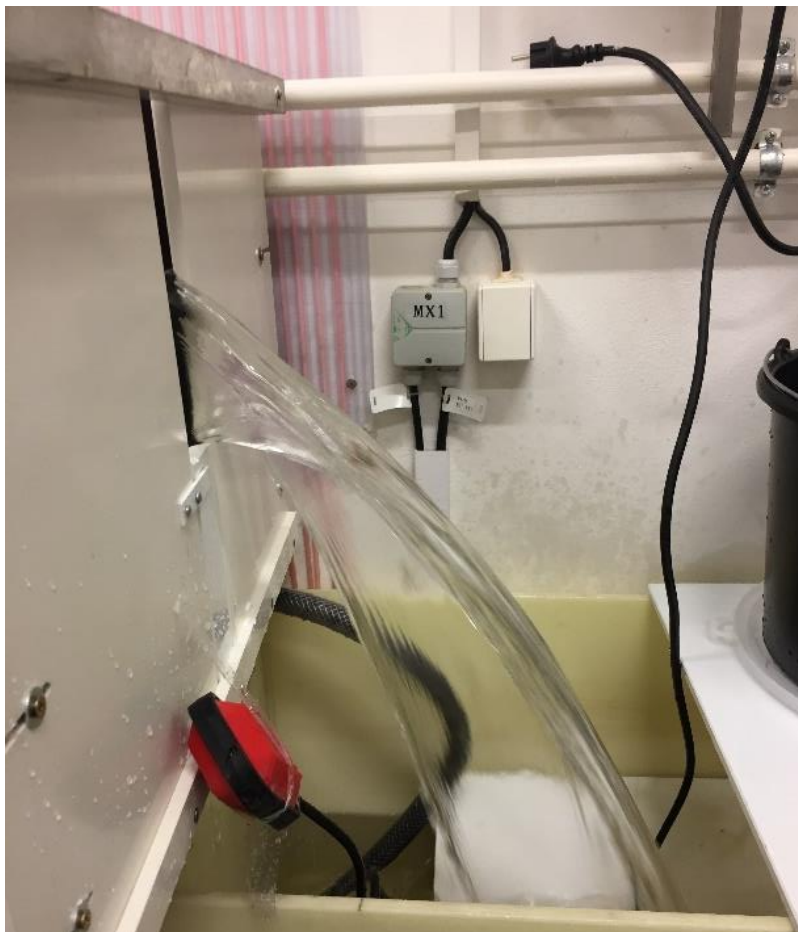
Obr. 16 Přepadový paprsek, šířka štěrbiny 0,050 m, přepadová výška 0,12 m
