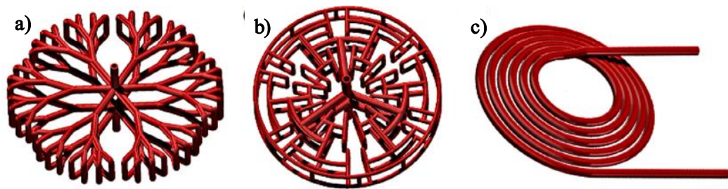
Obrázek 3.3 Schématické zobrazení geometrie fractal-tree heat exchangers, a) typ „Y“, b) typ „H“, c) konvenční
