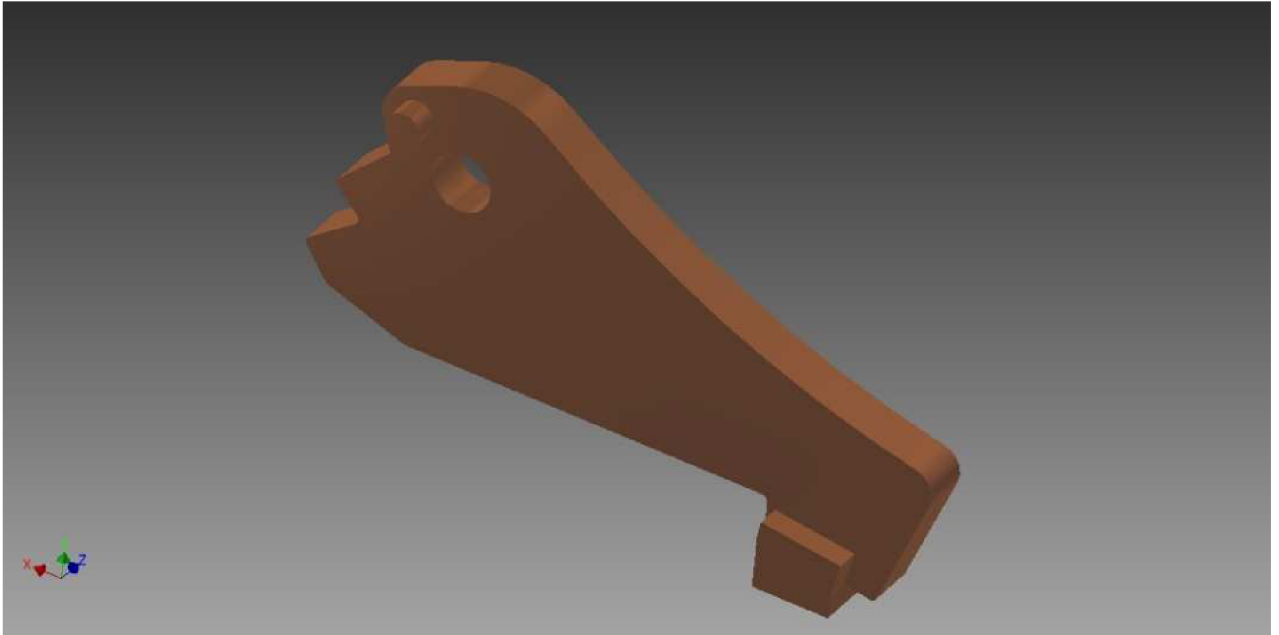
Obrázek 3-3: Vrchní pohyblivý kontakt jističe
