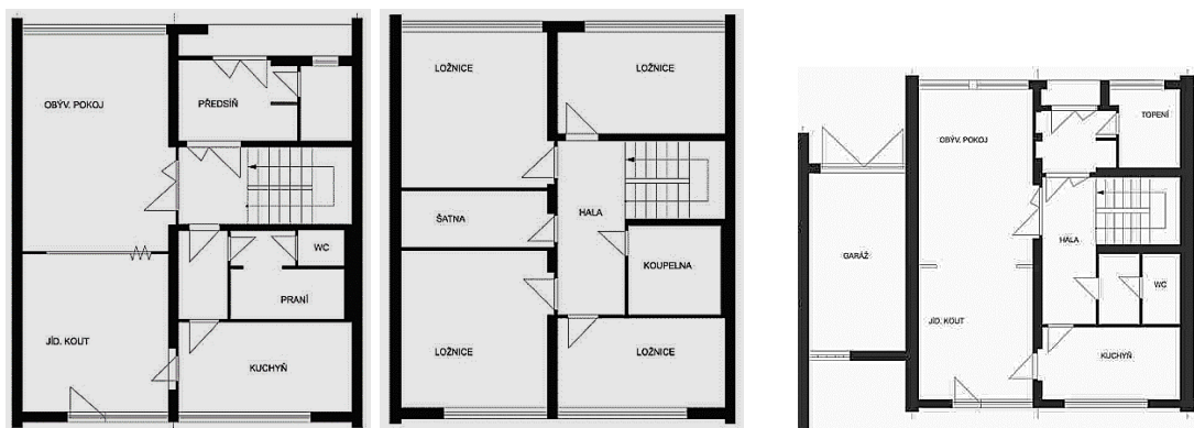
Obr. 153. Obytný soubor na Babě II. Půdorys 1.NP a 2.NP rodinného domu. Typ H.
