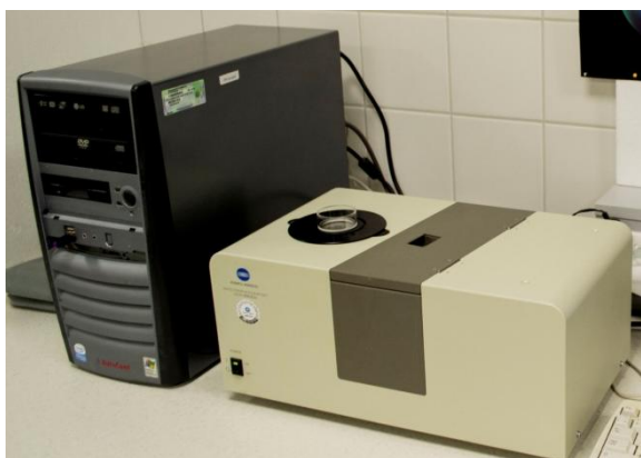
Obr. 4 Přístrojové vybavení pro stanovení barevného prostoru CIELAB (Foto: Jůzl)
