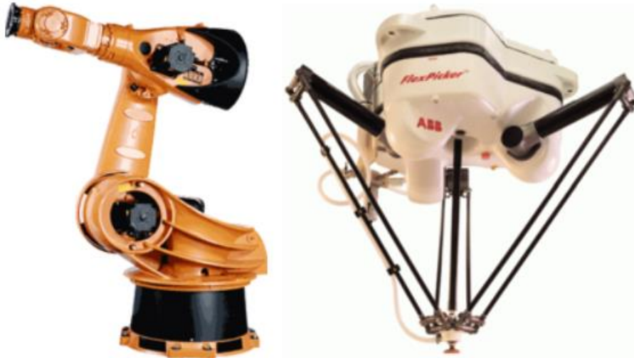
Obr. 1) Průmyslový robot se sériovou (vlevo) a paralelní (vpravo) kinematikou [4]
