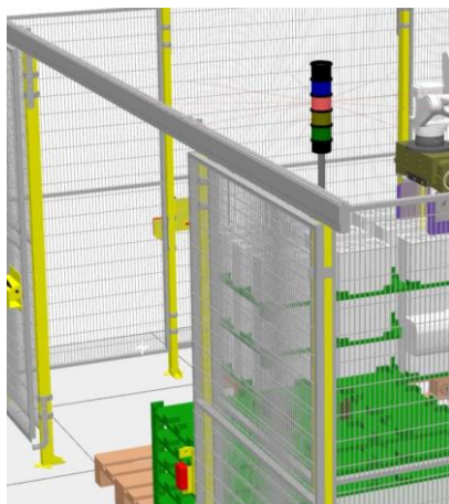
Obr. 32) Světelný maják signalizující porušení bezpečnosti otevřením dveří
