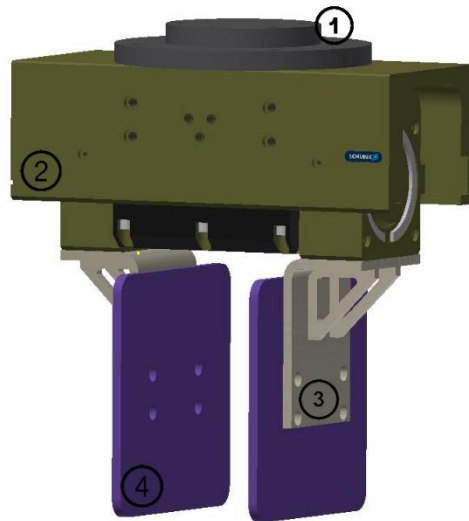
Obr. 23) Koncový efektor vlastní konstrukce: (1) příruba, (2) chapadlo, (3) prst, (4) deska prstu
