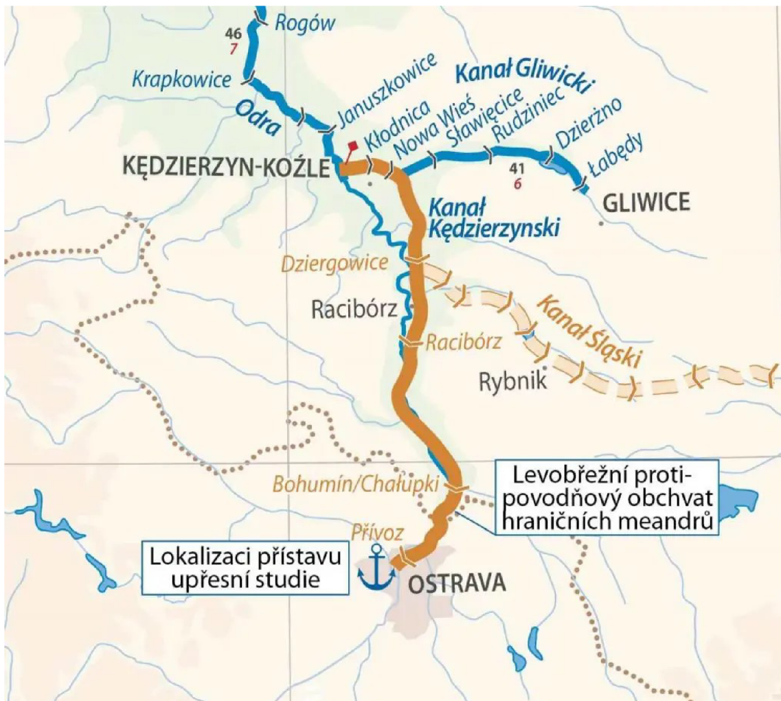
Obr. 3.1 Plánovaný kanál vyhýbající se meandrům
