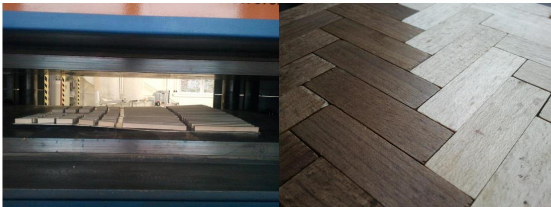
Obrázek 10: Tělíska uložená v hydraulickém lisu, porovnání upravených (40 min) a neupravených vzorků (foto autor)
