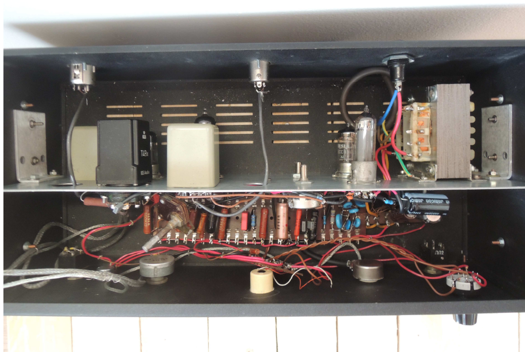
Obr. 4.2 pohled do vnitřního zapojení kompresoru LA2A.
