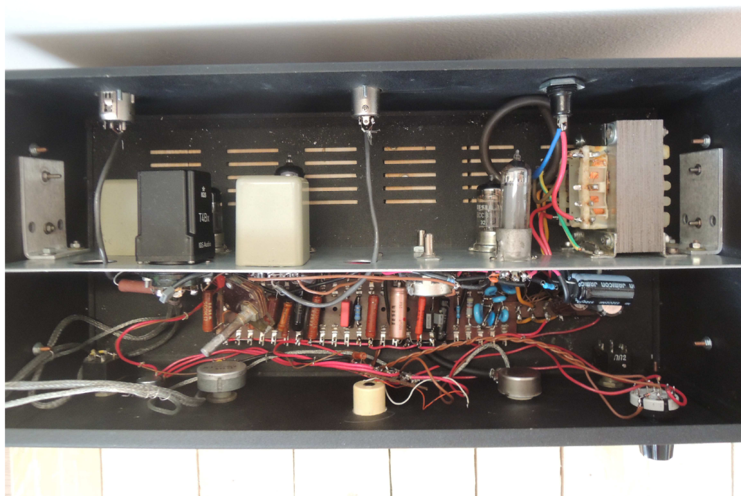
Obr. 4.2 pohled do vnitřního zapojení kompresoru LA2A.
