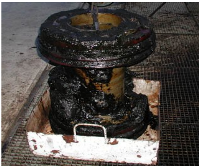
Obrázek 5: Čistící ježek s parafinickými usazeninami po vyjmutí z ropovodu
