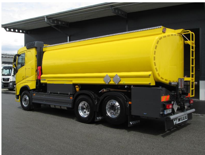
Obrázek 12: Automobilová cisterna Volvo, úprava Willig Silmet 21 500 litrů
