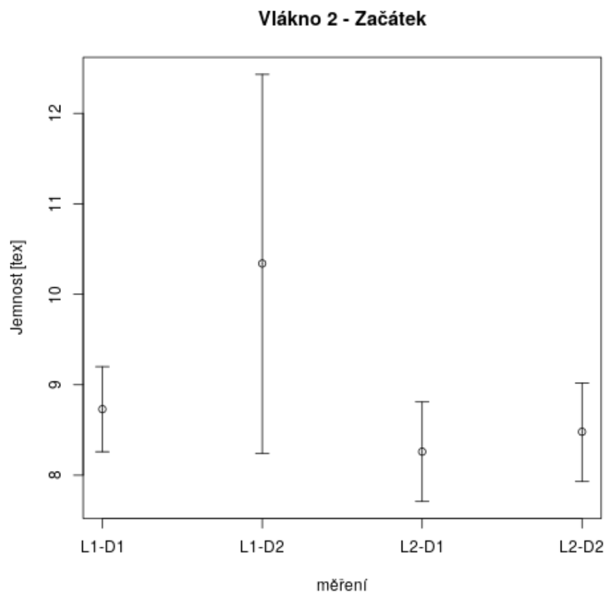
Obrázek 9: Gravimetrické měření jemnosti – Vlákno 2 – Začátek, Intervaly spolehlivosti (Hornův postup)
