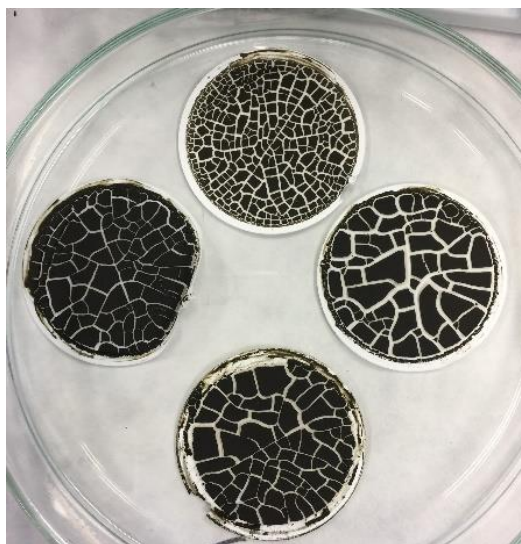
Obr. 13 Ukázka pevné fáze sorbentů získané po filtraci (autor fotografie: T. Dudková, 2019)
