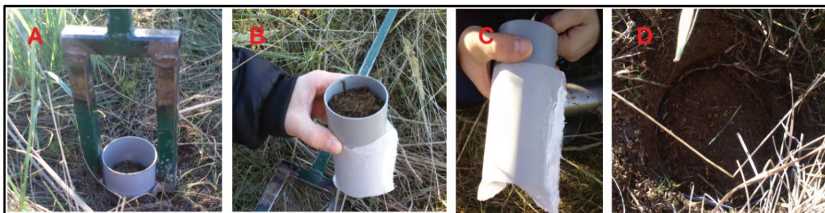
Obr. 4-16 Postup přípravy bezkořenové zóny (autor).
