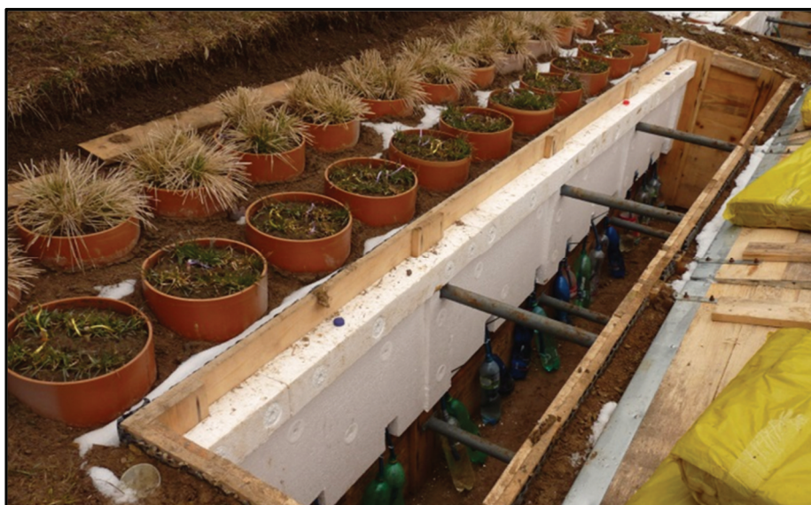
Obr. 4-10 Kontrolní šachta se zásobními nádobami pro zachycení eluátu (autor).
