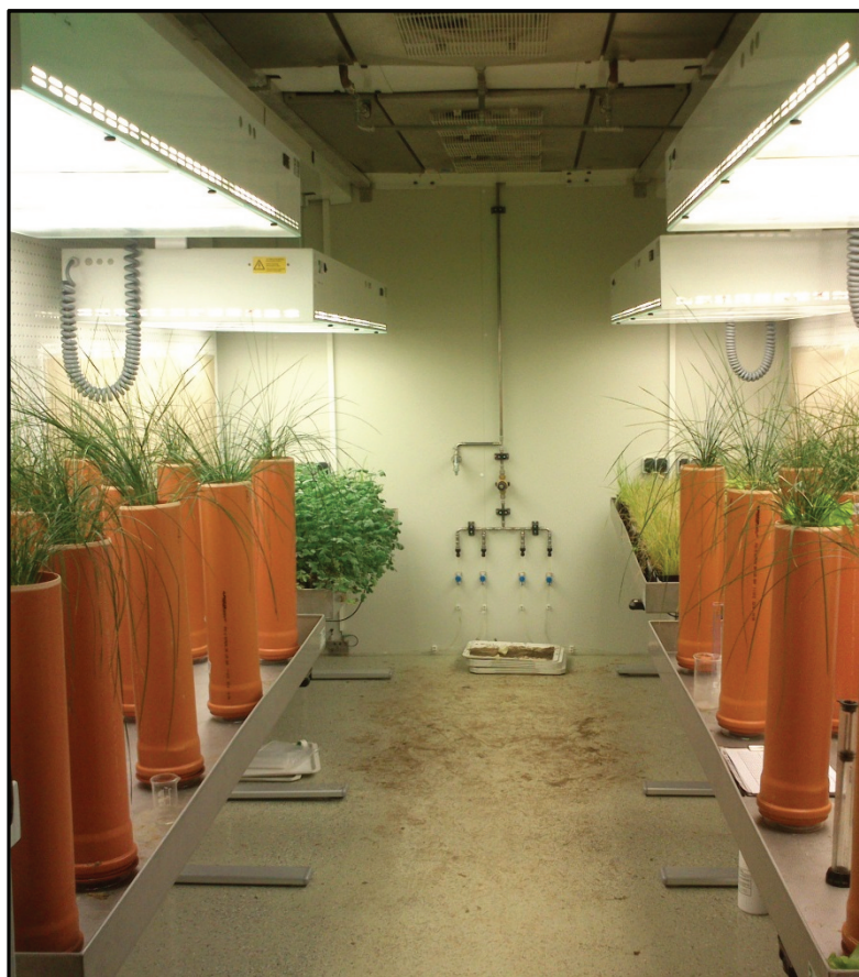
Obr. 4-20 Umístění experimentálních nádob v růstové komoře (autor).
