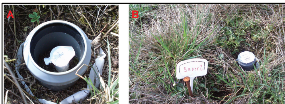
Obr. 4-18 Měření půdní respirace za využití aparatury z PVC a natrokalcitu na lokalitě Havraníky (autor).
