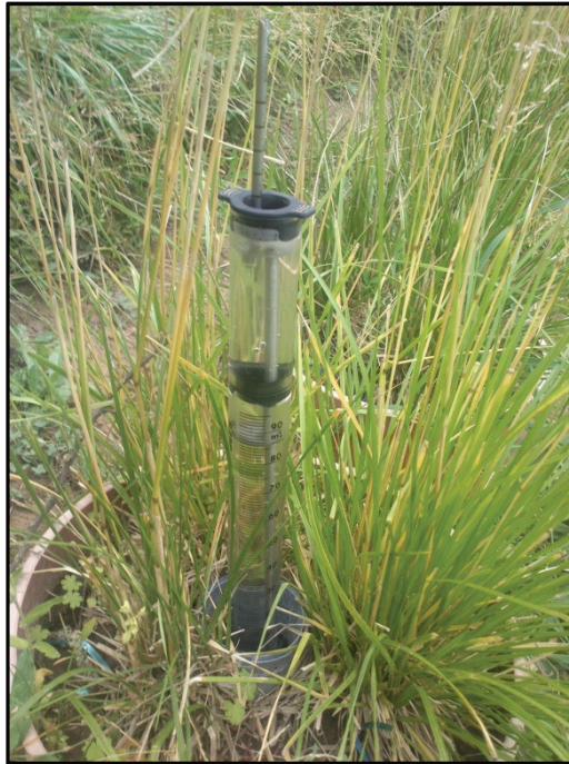
Obr. 4-13 Měření kumulativní vodní infiltrace v mimokořenové zóně (autor).
