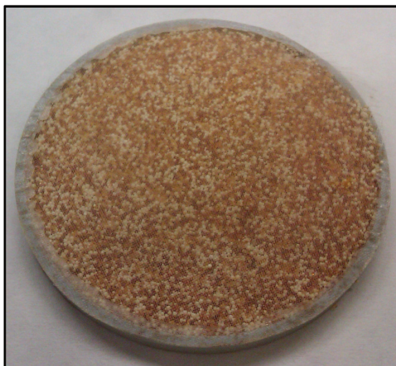
Obr. 4-21 Plastový disk (PVC) naplněný směsí AER a CER v poměru 1:1 (autor).
