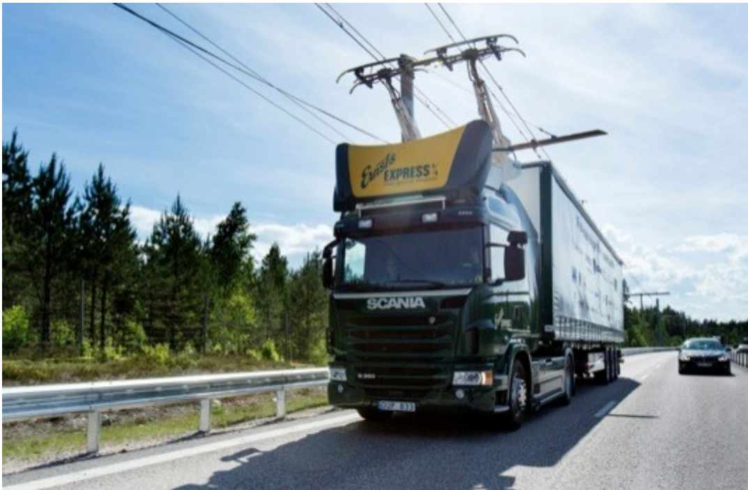
Obr. 2.8 Nákladní vozidlo poháněné externím zdrojem
