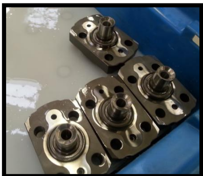
Obr. 13: Ukázka produktu vyráběného na CNC strojích INDEX - válce (cylindry) Zdroj: vlastní
