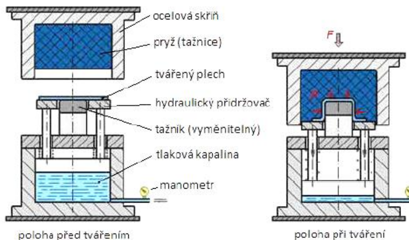
Obr. 1.6 Schematický proces tažení Metaform [13].
