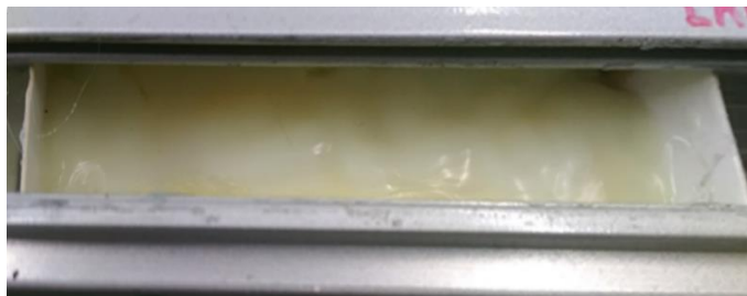
Obr. 4.1 Vytvrzená hmota A (nerovný povrch).
