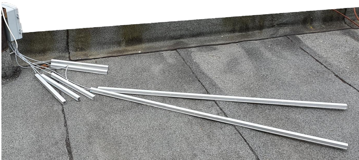
Obr. 6.3 Umístění svítidel na střeše pro venkovní dlouhodobý test.
