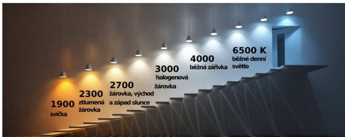
Obr. 1.13 Teplota chromatičnosti žárovek [9].
