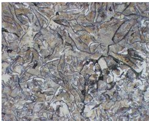
Obr. 2.5 Litina s lupínkovým grafitem s matricí feriticko-perlitickou [2].
