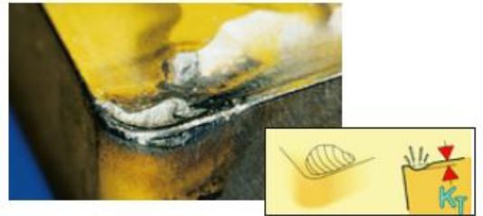
b) opotřebení ve tvaru žlábků
