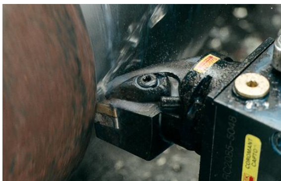
Obr. 3.2 Soustružení litinového obrobku [9].
