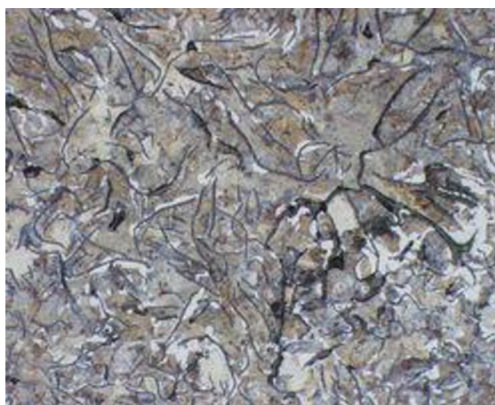
Obr. 2.5 Litina s lupínkovým grafitem s matricí feriticko-perlitickou [2].
