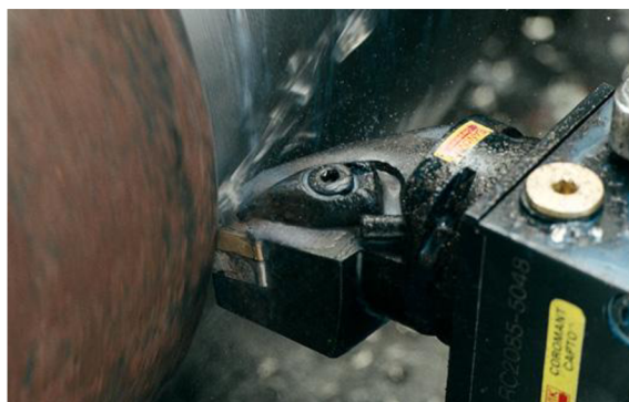
Obr. 3.2 Soustružení litinového obrobku [9].
