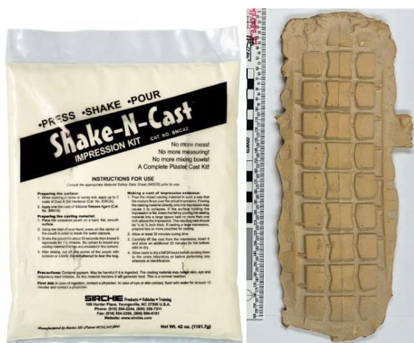
Obr. 12 – Shake-N-Cast a jím vytvořený odlitek pneumatiky
