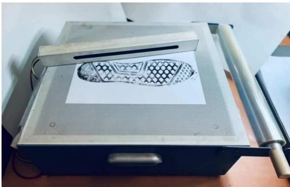
Obr. 15 – Zařízení pro elektrostatické snímání Vakuum box
