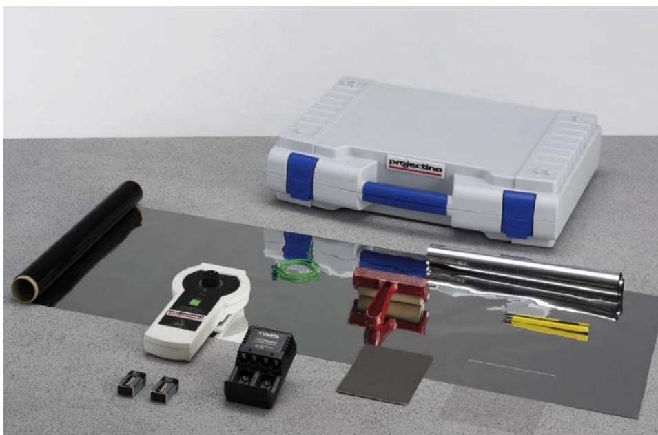
Obr. 14 – Souprava pro elektrostatické snímání Dustprint – lifter
