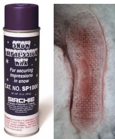
Obr. 13 – Snow Wax a jím fixovaná a současně zvýrazněná stopa podešve obuvi ve sněhu
