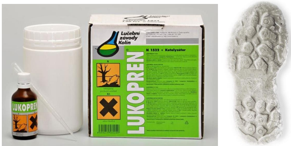
Obr. 9 – Lukopren a jím vytvořený odlitek podešve obuvi
