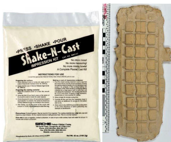
Obr. 12 – Shake-N-Cast a jím vytvořený odlitek pneumatiky
