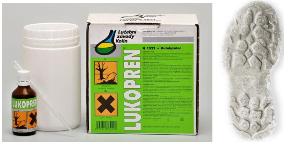
Obr. 9 – Lukopren a jím vytvořený odlitek podešve obuvi
