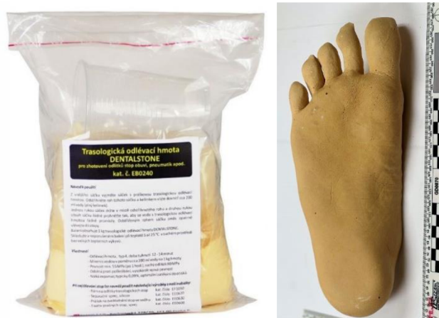
Obr. 11 – Dentalstone a jím vytvořený odlitek chodidla
