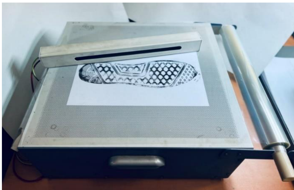
Obr. 15 – Zařízení pro elektrostatické snímání Vakuum box
