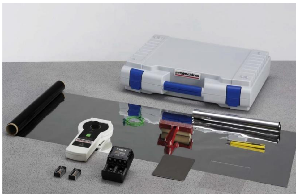
Obr. 14 – Souprava pro elektrostatické snímání Dustprint – lifter
