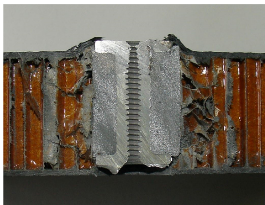
Obrázek 3.8: Poškození panelu při vytrhávací zkoušce. Převzato z [19].
