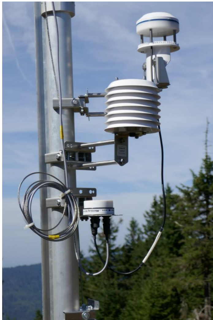
Obr. 13 Senzory pro měření směru a rychlosti větru (Modlinger R. 2019)
